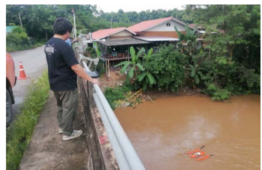
รูปที่ 5.8-6 ทำการสำรวจปริมาณน้ำและการสำรวจตะกอนแขวนลอยสถานี P.92A น้ำแม่แตง บ้านห้วยป่าซาง อำเภอแม่แตง จังหวัดเชียงใหม่
