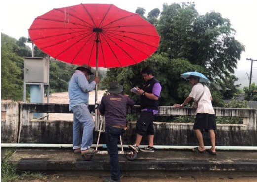
รูปที่ 5.8-4 ทำการสำรวจปริมาณน้ำและการสำรวจตะกอนแขวนลอยสถานี P.92 น้ำแม่แตง บ้านเมืองก๊ิด อำเภอแม่แตง จังหวัดเชียงใหม่
